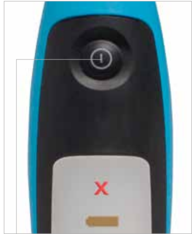
Gumb za pokretanje/zaustavljanje za pokretanje/prekid postupka polimerizacije
